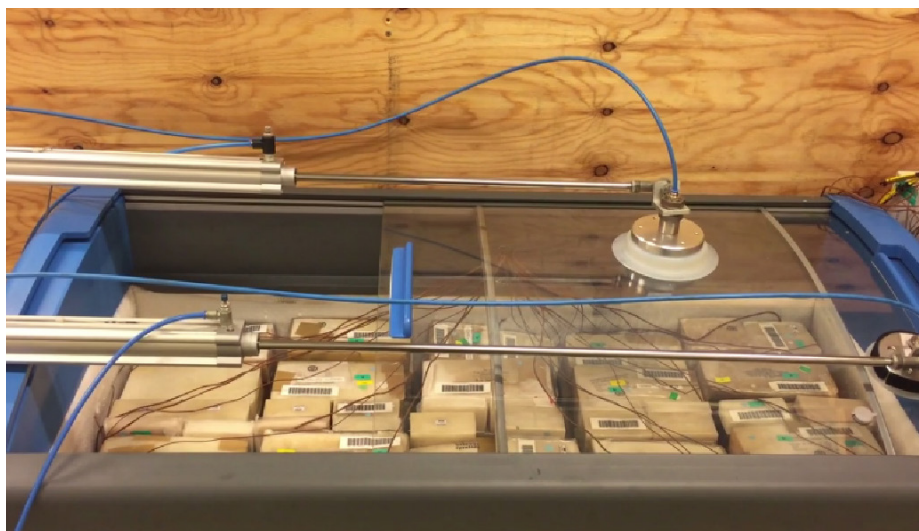
Foto af prototype af Fokus 131 kommercielt og under akkrediteret døråbningstest i klimakammer på Teknologisk Institut.
